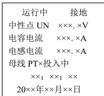
当电网系统发生单相接地时，屏幕显示：中性点电压值、电网电容电流值、补偿的电感电流值、母线 PT 号、当前时间等；报警接点输出；接地指示灯亮；仪表盘的仪表都有相应显示。
